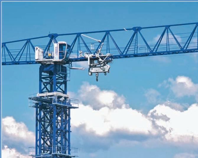
El sistema de doble carro diseñado por **Linden Comansa**, se compone de un carro/gancho trasero y un carro/gancho delantero que pueden trabajar por separado o conjuntamente según las necesidades de la carga. El cambio de carros es **automático**.
